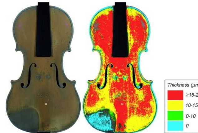
Analisi dello spessore del corpo del violino
